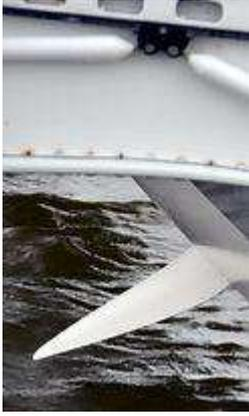
La nouvelle version des foils d'IDEC Sport. Un foil en forme de "J", qui va permettre de soulager le flotteur et de le rendre plus "aérien".
